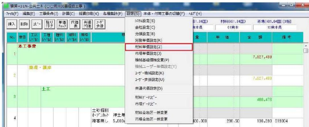
下記画面が表示されます。左画面は分類項目で、大まかな検索をこちらで行い、右画面に登録材料単価が表示されます。登録または変更したい材料コードにマウスを合わせダブルクリックするか Enter を押してください。
