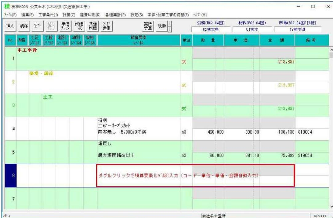
コード選択画面が表示されますので、“土工” → “機械運搬工” → “19007 土砂等運搬ダンプトラック(施工パッケージ型)”の順に選択して  ボタンをクリックするかダブルクリックして下さい。
