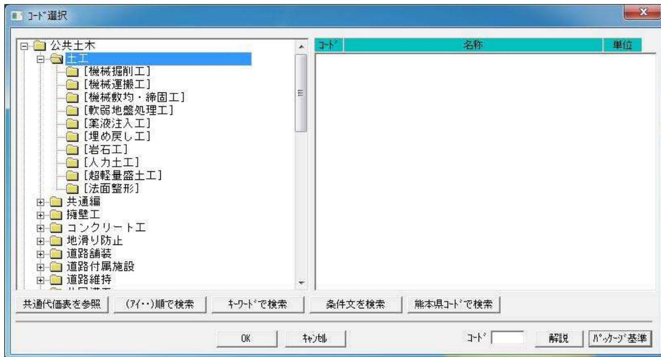
“土工”の  をクリックすると土工を構成するグループが表示されます、さらにその中で掘削がありそうな”機械掘削工”を開きます。すると画面右側に機械掘削工の歩掛が表示されます。
